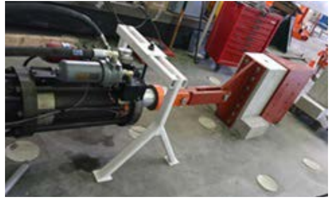
Figura 12. Probeta durante fisuración.
