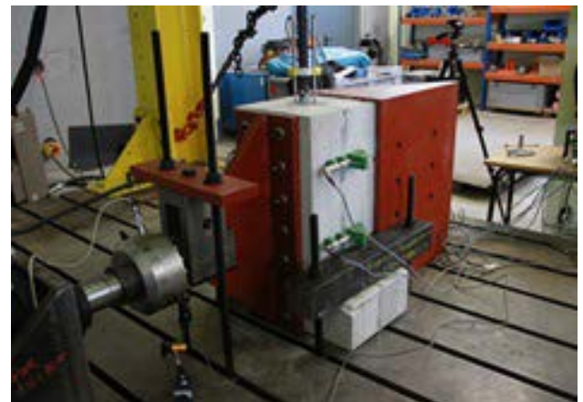
Figura 14. Montaje ensayo de tracción.
