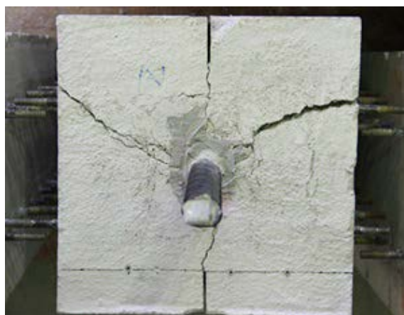
Figura 18. Probeta ensayada a cortante.
