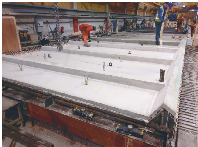
Figura 9. Panel prefabricado de alma inclinada.
