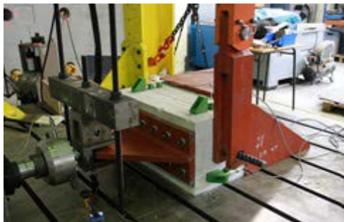
Figura 17. Montaje del ensayo de cortante.
