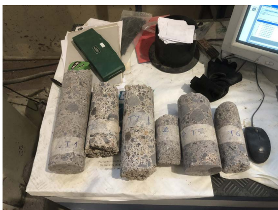
Figura 11. Testigos de hormigón extraídos de los restos del Seminario Diocesano. Fotografía del autor.
