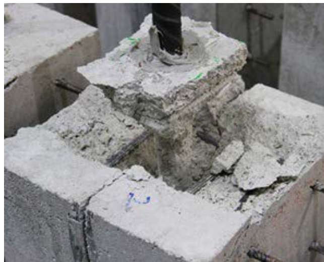
Figura 16. Probeta rota en ensayo de tracción.
