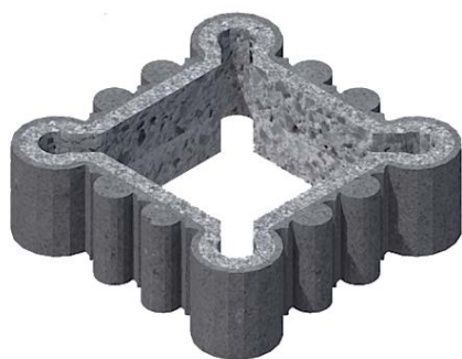
Figura 4. Moldes prefabricados para las columnas. Dibujo de Hugo Ventura Rodríguez.
