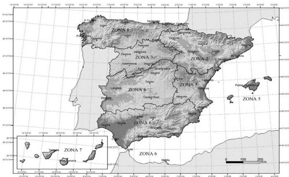
Figura 10. Zonas climáticas de invierno. (Figura E.2 del anejo E del DB SE-AE del CTE-2006 [8])
