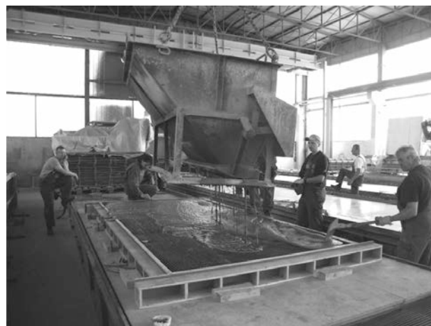
Figura 5. Hormigonado de prueba de una losa de balcón de hormigón armado con textiles [15]
