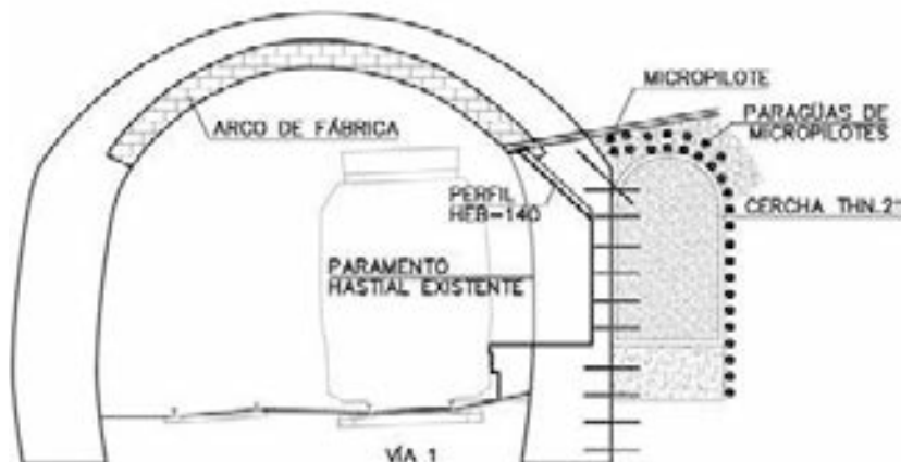
Figura 7. Solución adoptada en el andén lado Norte
