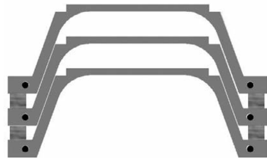
Figura 9. Sistema de apilado de los elementos primarios
