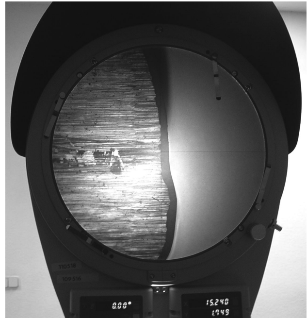
Figura 8. Medida del espesor de revestimiento de resina epoxi con un proyector de perfiles
