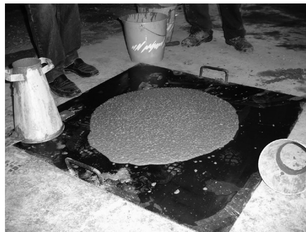
Figura 7. Dosificación 1: vista general del ensayo de extensión de flujo
