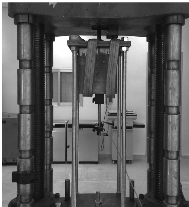
Figura 18. Vista general del ensayo de arrancamiento (pull-out)
