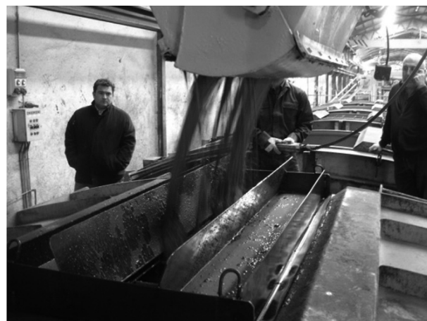
Figura 16. Adaptador de vertido acoplable que redujo la abertura del molde
