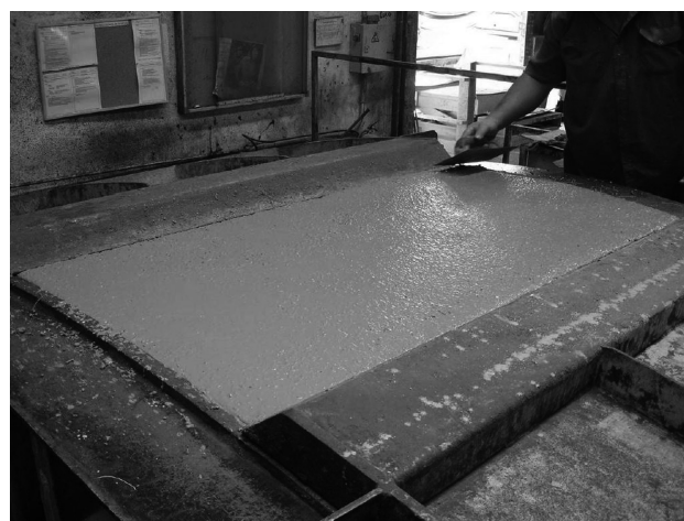
Figura 14. Enrasado de una de las dovelas producidas con la dosificación 3
