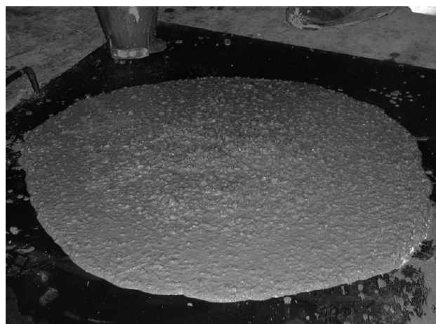
Figura 9. Dosificación 3: vista general del ensayo de extensión de flujo
