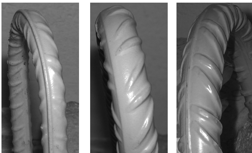
Figura 6. Barras de los tres diámetros tras el ensayo de doblado a 180°. No se aprecian daños en el revestimiento de resina epoxi
