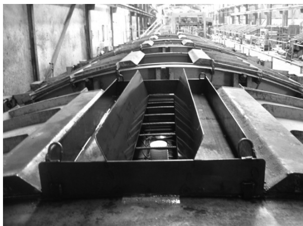
Figura 16. Adaptador de vertido acoplable que redujo la abertura del molde
