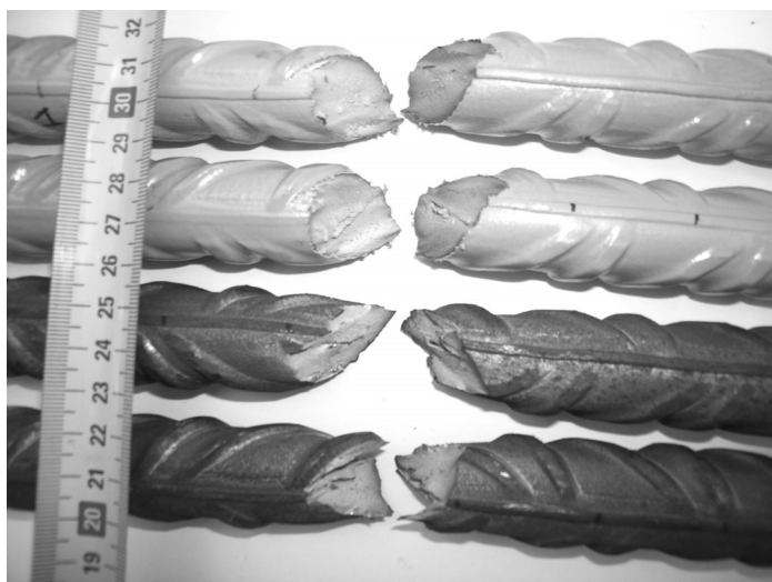
Figura 4. Barras tras el ensayo de tracción
