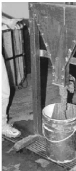
Figura 5. Ensayo de embudo en V.
