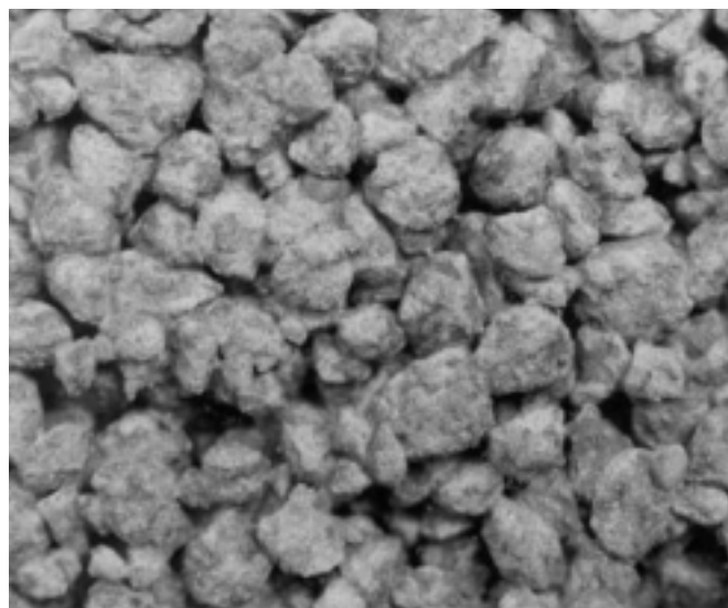
Fogografía 9. Hormigón poroso pavimento.
