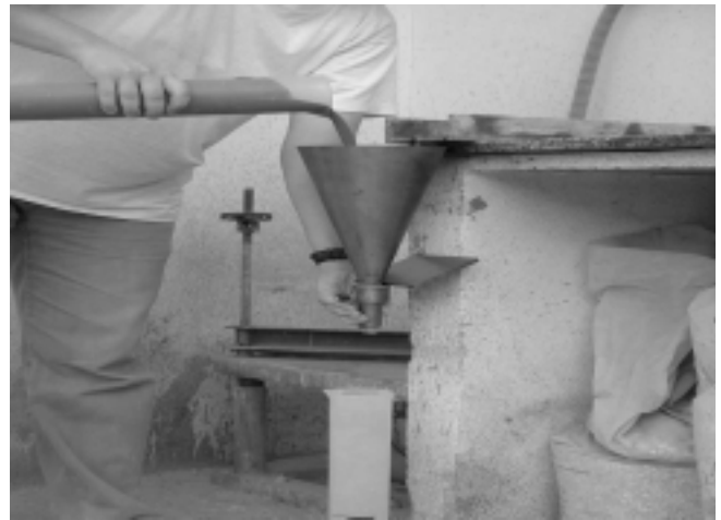
Fig. 4. Ensayo de Cono de Marsh
