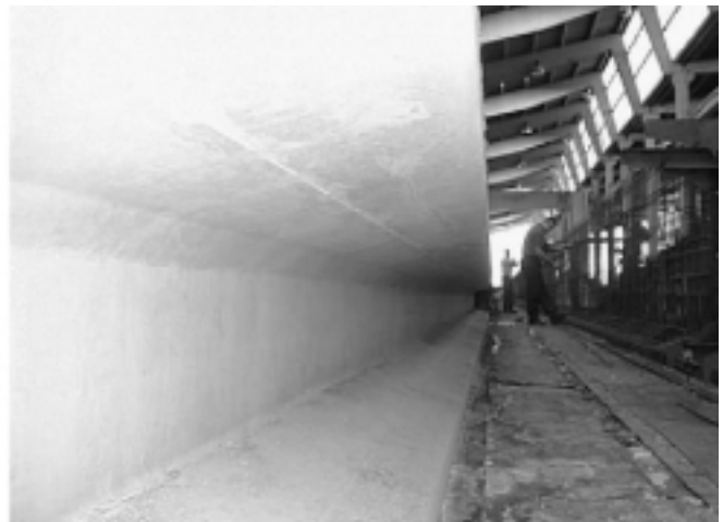
Foto 24. Acabados en vigas doble T prefabricadas. Izquierda con hormigón fluido convencional, derecha con HAC.
