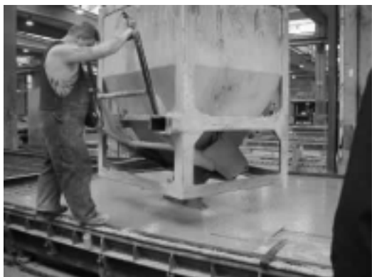
Figura 2. Fabricación de una losa prefabricada con HAC.
