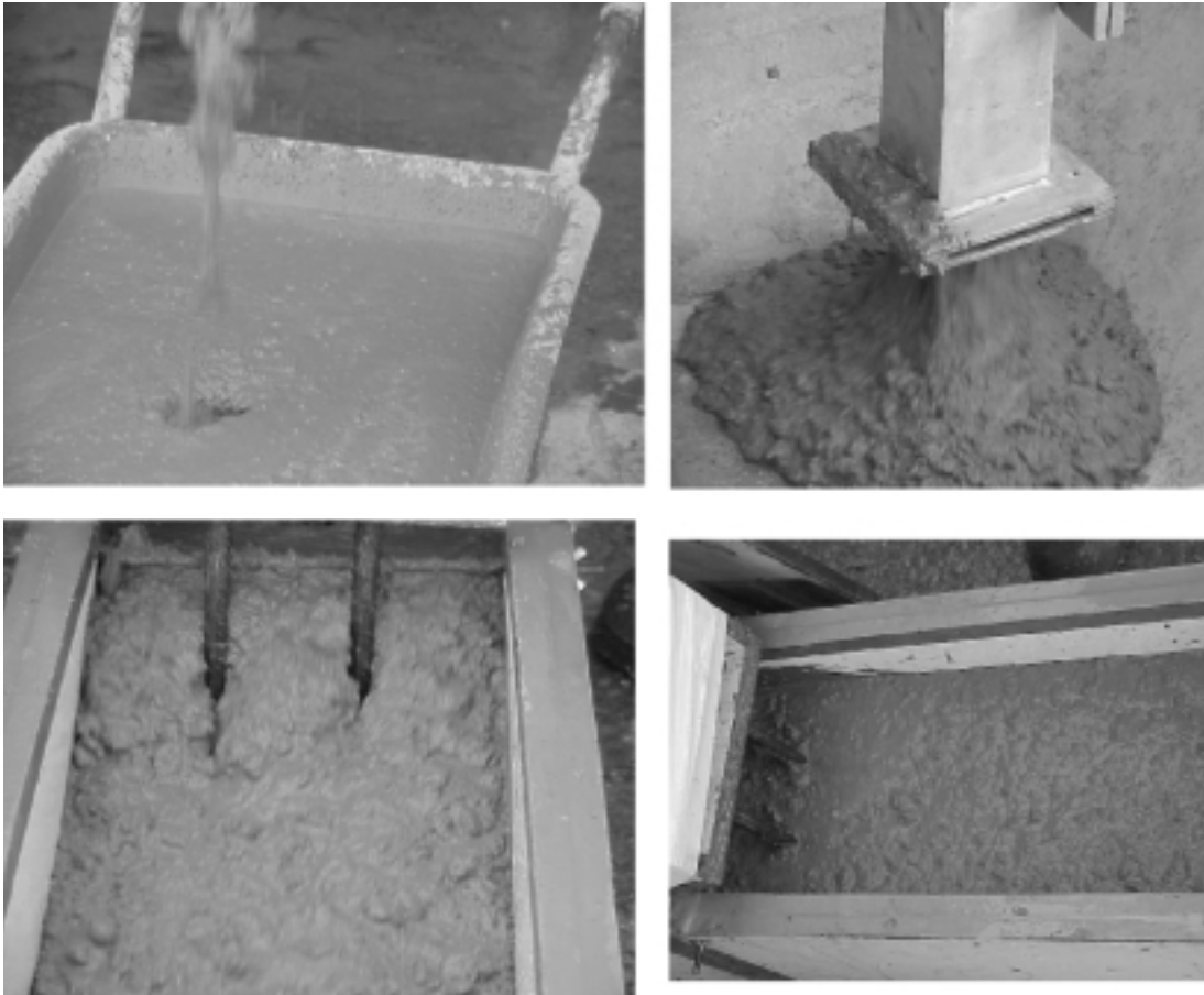
Foto 15. Ensayos para el diseño de un HAC posteriormente aplicado en un pavimento.
