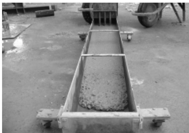
Fig. 3. Ensayo de Caja L-Box
