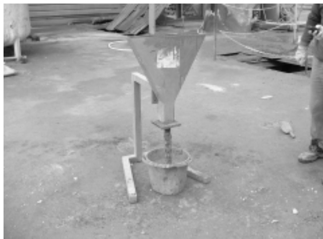
Fig. 2. Ensayo de embudo V-Funnel.
