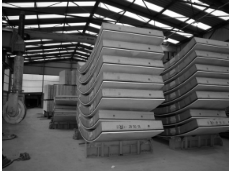
Foto 11. Túnel de Oenzberg. Apilado de dovelas.
