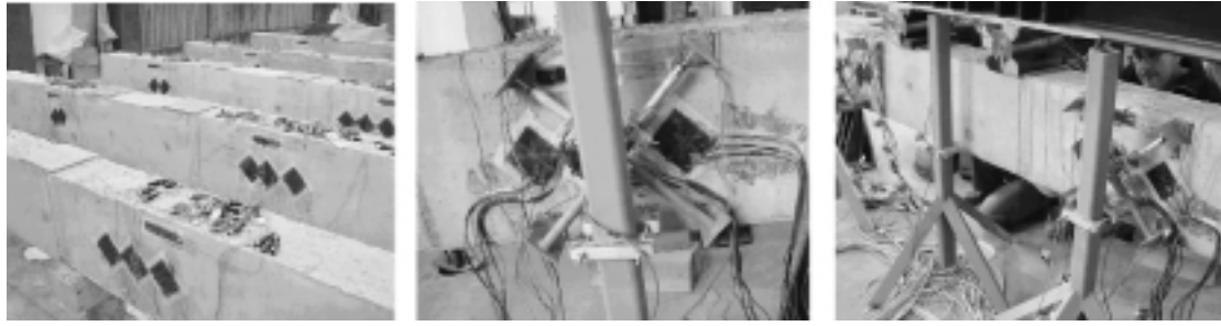
Instrumentación del hormigón. Galgas de roseta y unidireccionales
