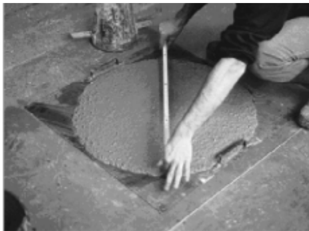
Figura 4. Ensayo de escurrimiento.
