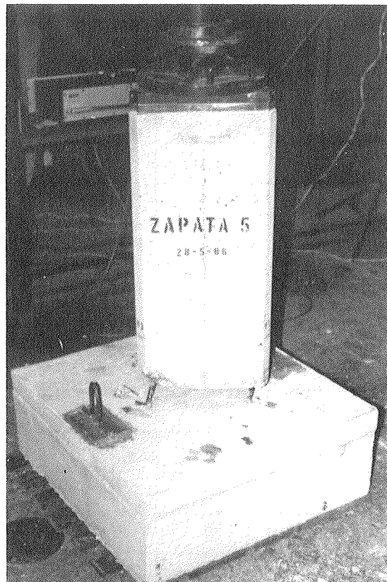
Fig. 9. Rotura por inestabilidad del pilar.
