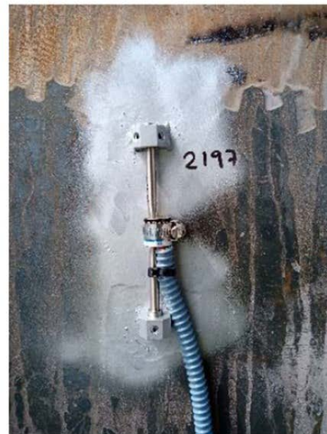
Figura 13. Secciones de control y ejemplo de galga instalada.
