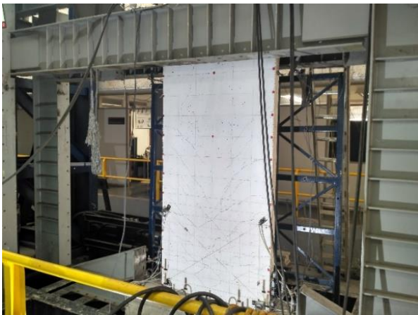
Figura 3. Montaje de los muros en el Marco de pruebas.
