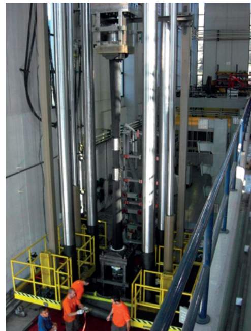
Figura 5. Ensayo de fatiga y rotura de tirante.
