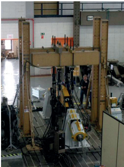
Figura 4. Ensayo de fatiga de la silla.
